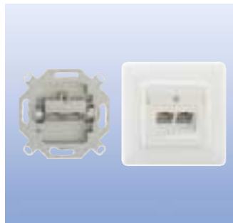
UAE-Cat.6-8/8 Up mK 136 102 05 z elementem środkowym i płytką przykrywającą; z pazurami rozpórkowymi; perłowo-biały (podobny RAL 1013); 80 x 80 x 41 mm; 155 g
